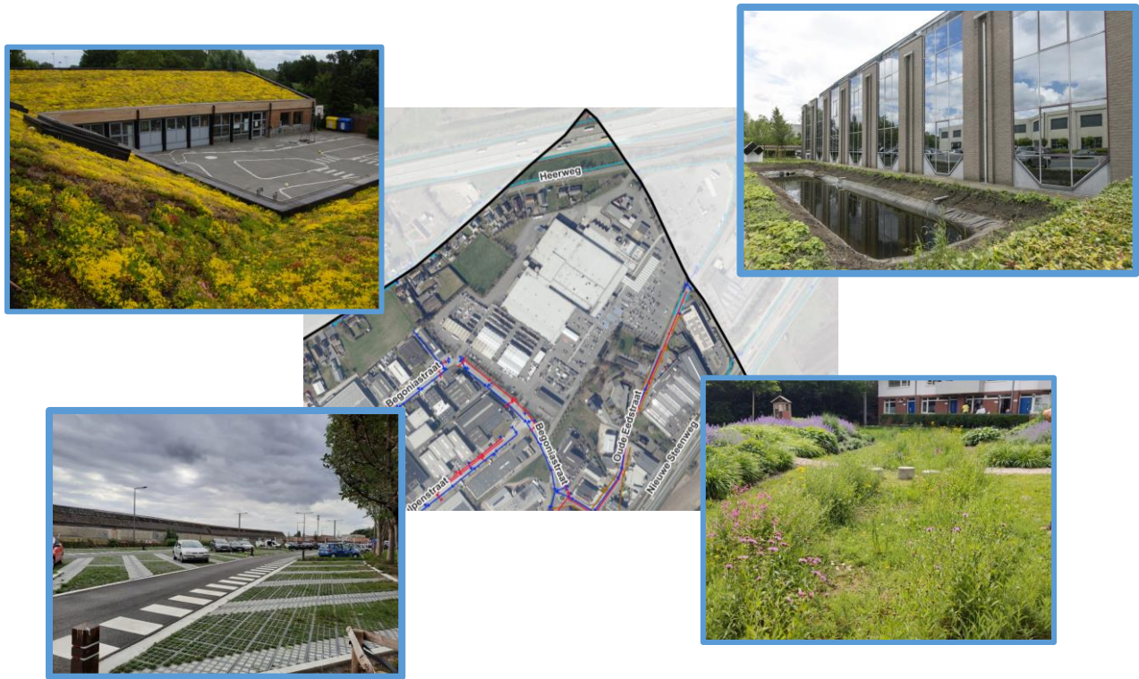
Figuur 26: Maatregelen ter inspiratie voor een waterrobuuste herinrichting van de Makro-site: groendaken, opvang en hergebruik van hemelwater, waterdoorlatende verharding en wadi's.
