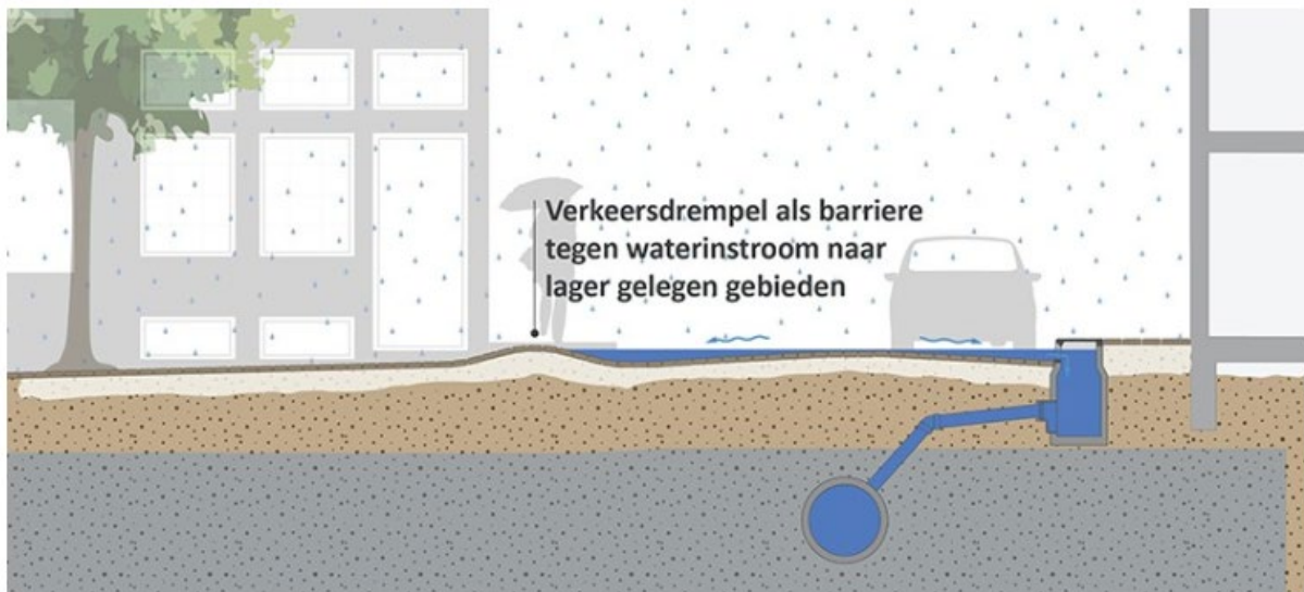
Schematische doorsnede van een strategisch geplaatste verkeersdrempel. ©Atelier GROENBLAUW
